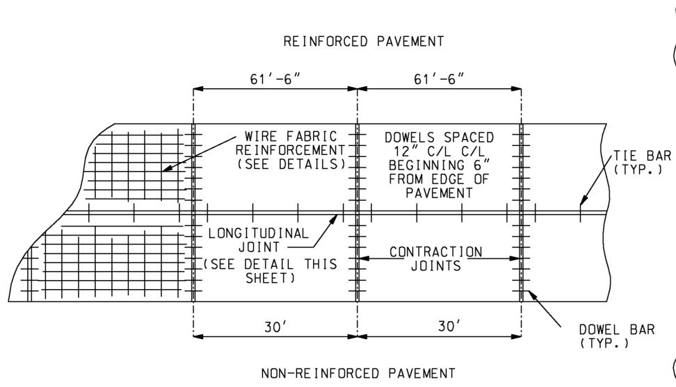
JOINT PLAN AND SPACING FOR CONTRACTION JOINTS
